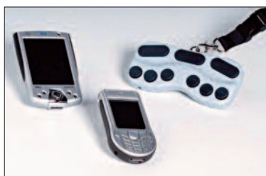
Obr. 49: Klávesnice Easy Link (na prvním obrázku bez vestavěného braillového řádku společně s kapesním počítačem PDA ve funkci zápisníku, na druhém obrázku s 12-ti znakovým řádkem)
