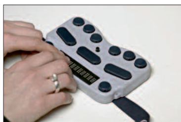
Obr. 49: Klávesnice Easy Link (na prvním obrázku bez vestavěného braillového řádku společně s kapesním počítačem PDA ve funkci zápisníku, na druhém obrázku s 12-ti znakovým řádkem)
