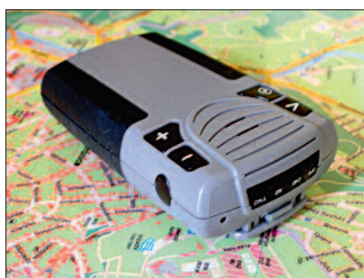
Obr. 62: Navigační jednotka, ultrazvukový vyhledávač překážek do ruky RAY a ultrazvukový vyhledávač překážek v brýlích
