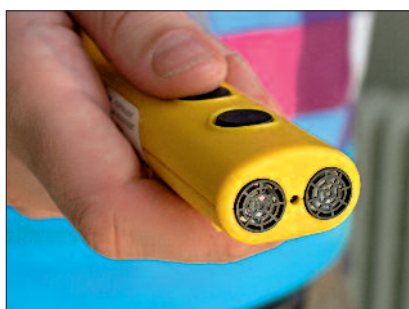
Obr. 62: Navigační jednotka, ultrazvukový vyhledávač překážek do ruky RAY a ultrazvukový vyhledávač překážek v brýlích
